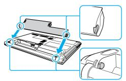
Déverrouillez le verrou **LOCK** de la batterie avant d'installer la batterie, puis verrouillez-le après l'installation.
