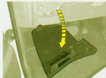
Accès au premier boîtier de fusibles sous la planche de bord
